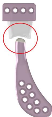
Figura 2 - Região do encaixe entre o Ramo Mandibular e a Fossa Condilar (Região condilar)
