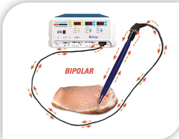
Figura 1 – Desenho Esquemático da Pinça Bipolar conectada ao gerador eletrocirúrgico – caminho da corrente.
