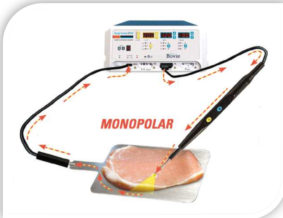
Figura 3 — Desenho Esquemático da Pinça Monopolar conectada ao gerador eletrocirúrgico — caminho da corrente.
