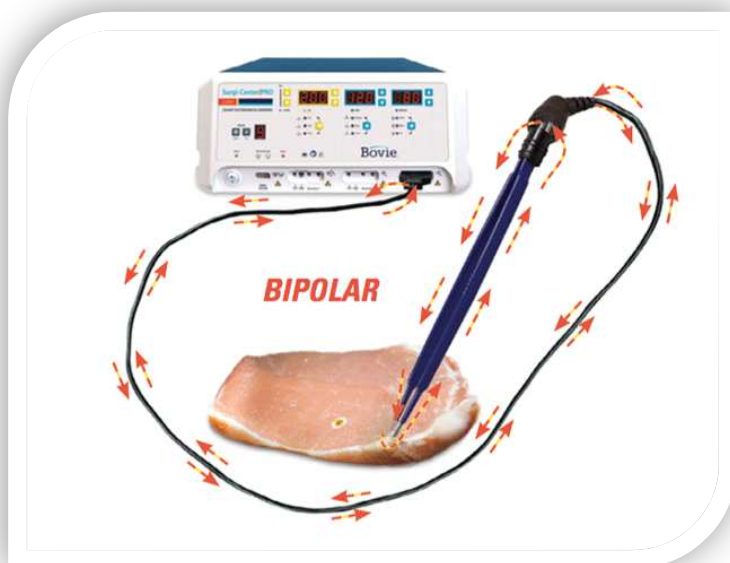
Figura 3 — Desenho Esquemático da Pinça Bipolar conectada ao gerador eletrocirúrgico — caminho da corrente.
