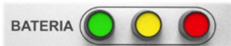
Como demonstrado na figura existem três leds indicando o nível da bateria, podendo trabalhar simultaneamente no estilo BARGRAFH.
